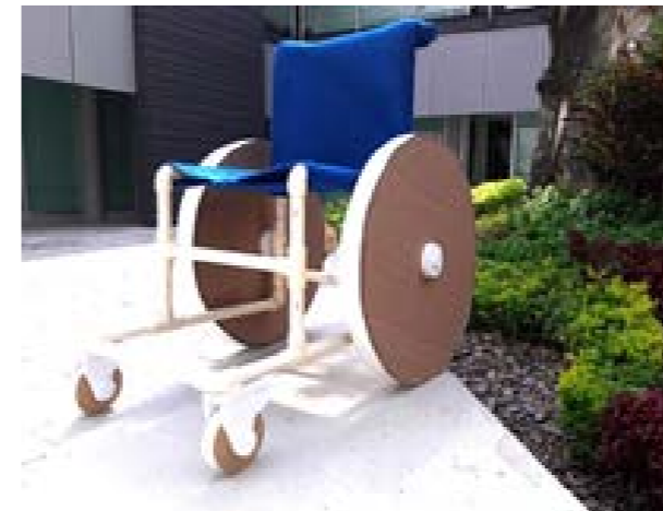
Imagen 6. Modelo escala 2:1 de la silla de ruedas a base de tubos de PVC.
